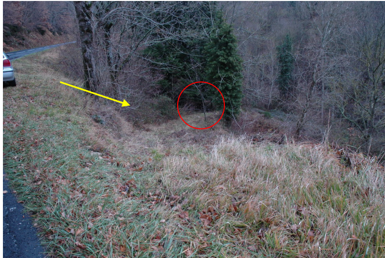
Figure 1 : Un chemin descendant permet d'accéder au captage situé dans le cercle rouge. Derrière l'arbre se trouve l'exutoire du caniveau de la route (flèche jaune). L'eau pluviale ainsi évacuée coule le long du chemin vers le captage.
