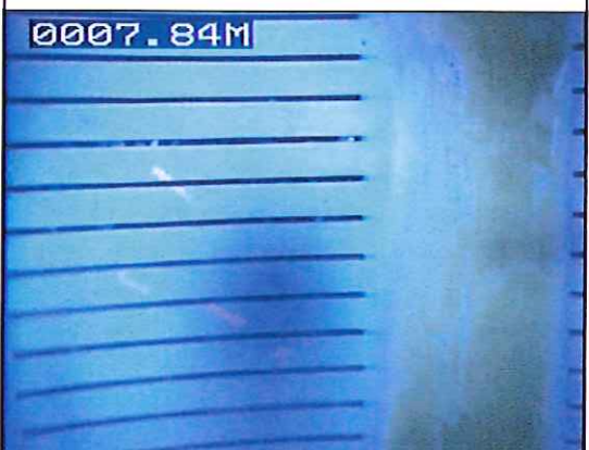
Tubage propre au niveau de la zone d'alimentation principale. Massif de graviers bien visible.
