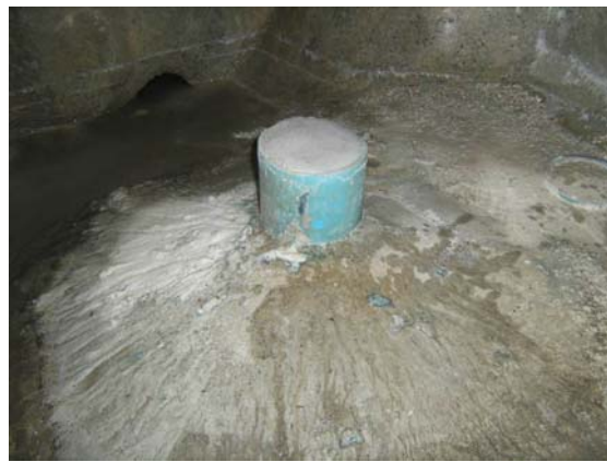
Figure 9b : tubage PVC rebouché du sondage S2bis
