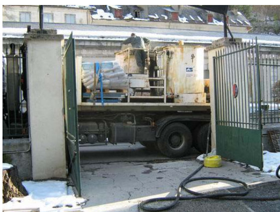
Figure 8g : Centrale de cimentation
