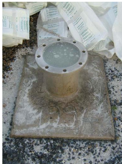
Figure 8f : Jaillissement très faible en fin de comblement par le gravier
