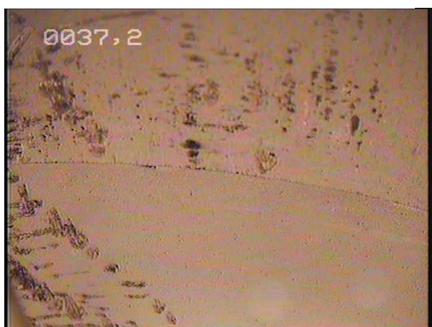
Photo 5 : 7 ème joint de tubage avec impact d'outil
