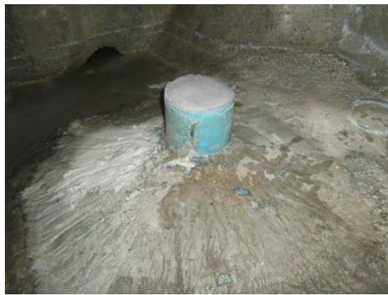
Figure 9b : tubage PVC rebouché du sondage S2bis
