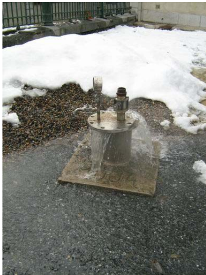
Figure 8a : Ouverture du forage FB1
