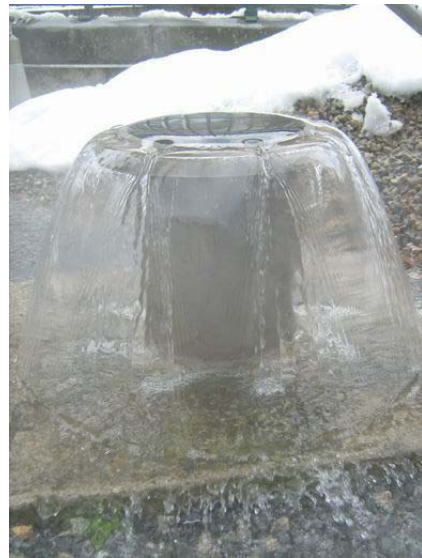
Figure 8b : Jaillissement du forage FB1
