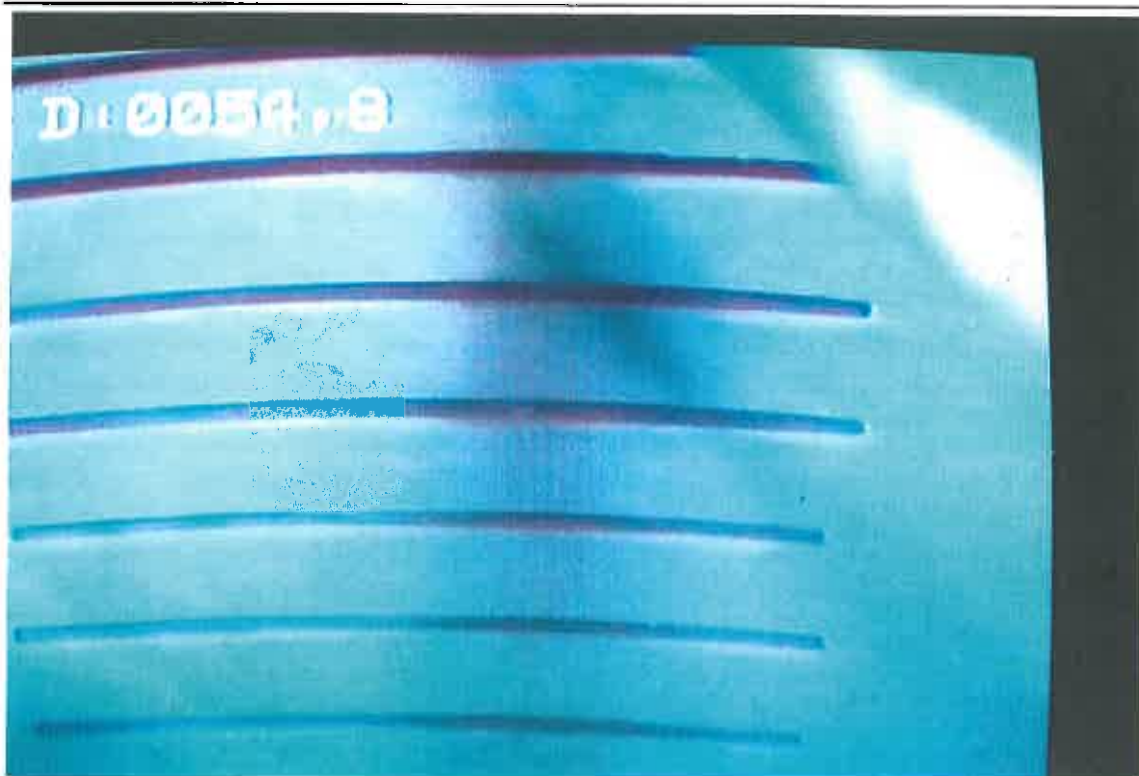
11- Tubage PVC crépiné – aspect propre, fentes ouvertes
