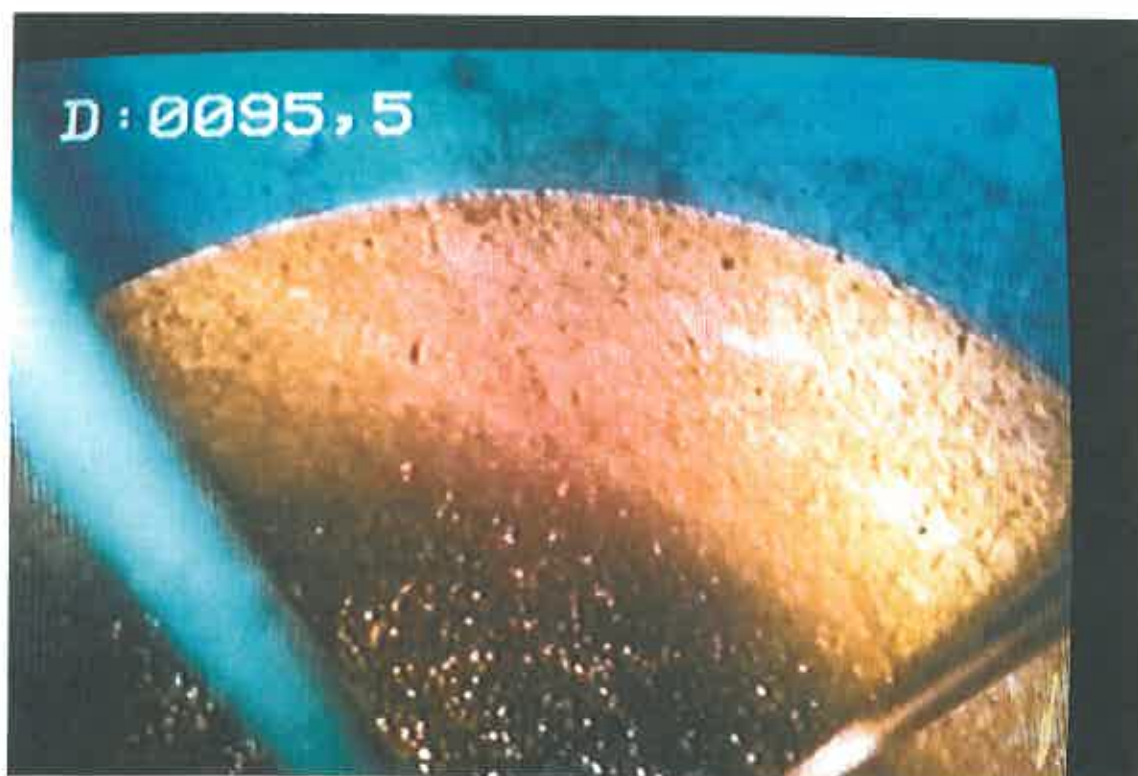
18- Base de tubage PVC et vue vers trou nu et base de colonne captante
