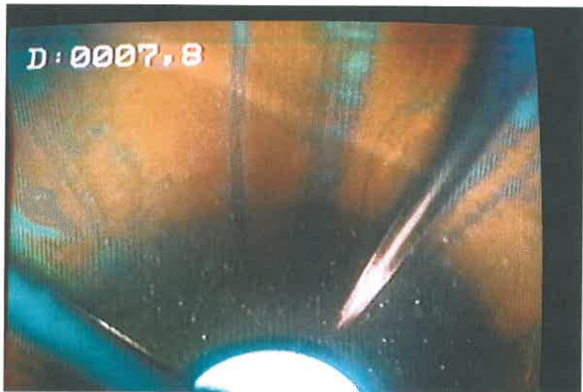
4- Tubage PVC lisse – dépôts tapissant le tubage
