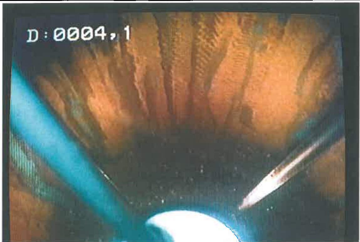
3- Tubage PVC lisse – dépôts tapissant le tubage
