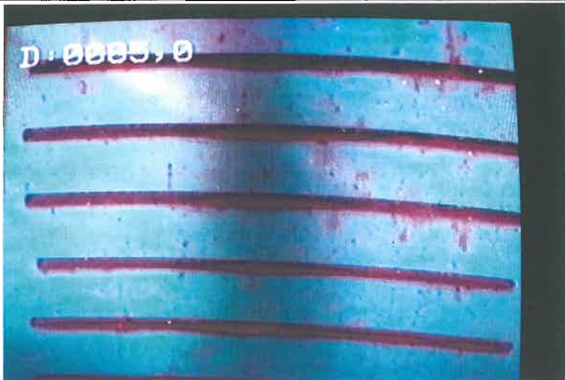
15- Tubage PVC crépiné – très légers dépôts, fentes partiellement colmatées
