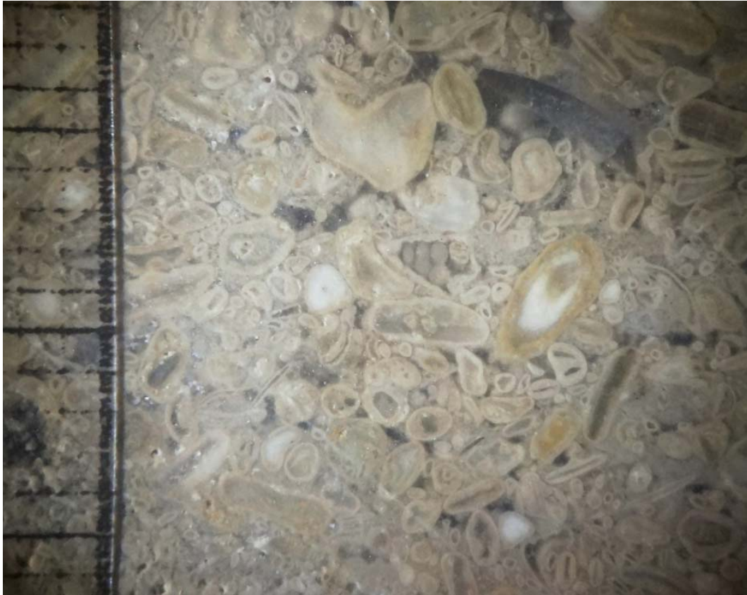
Fig. 9 : Echantillon CHA 2 : Lithofaciès à la base de l'unité 3 de la coupe est. Surface sciée traitée à l'acide chlorhydrique. Echelle millimétrique.
