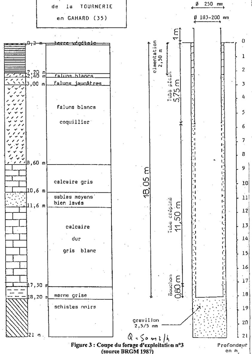
Figure 3 : Coupe du forage d'exploitation n°3 (source BRGM 1987)
