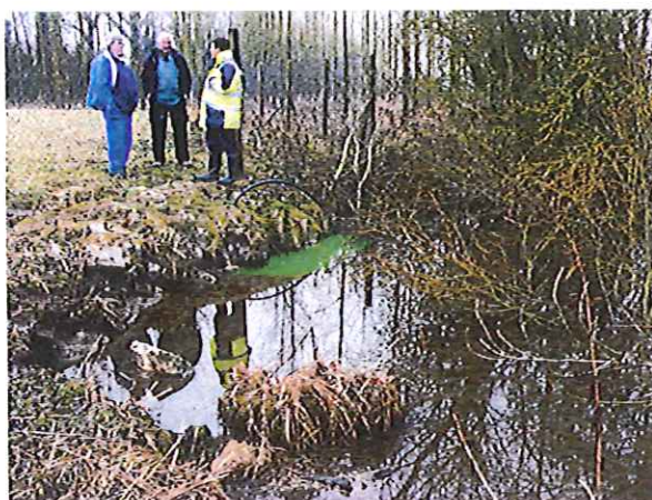
Figure 5: vue du blocage du panache de traceur contre la berge en pompage
