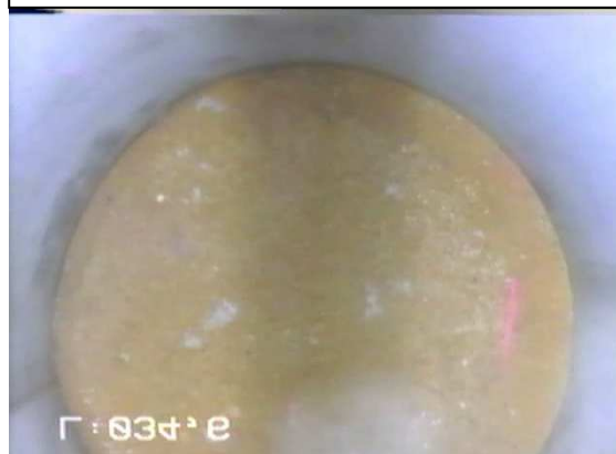
Fond du forage. Une légère décantation s'est opérée dans la « poubelle » = partie pleine en fond d'ouvrage.
