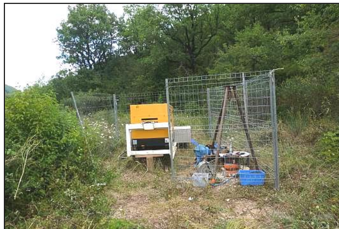
Vue des installations de pompage mises en place sur le forage F1/2008
