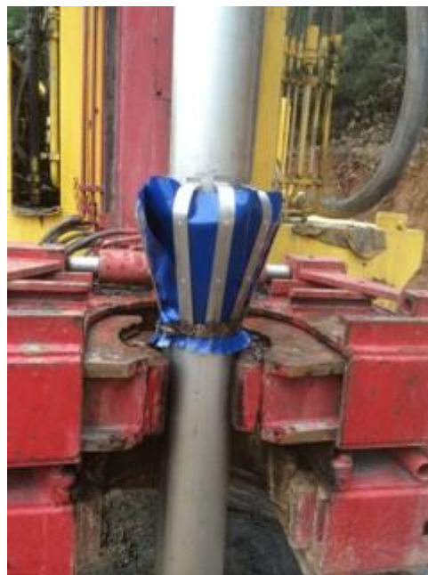
Photo 2 Centreur et ombrelle de cimentation
