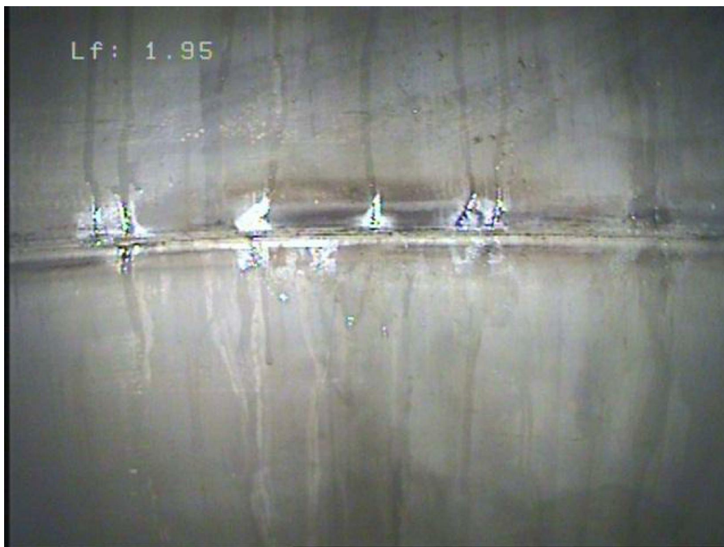
3- Tubage inox plein (-1.95 m) – premier raccord inter-tubes
