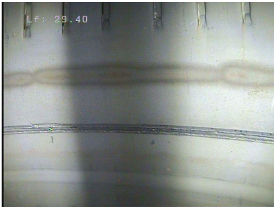
19- Tubage inox crépiné (-29.40 m) – raccord manchonné, trace de soudure, tubages jointifs
