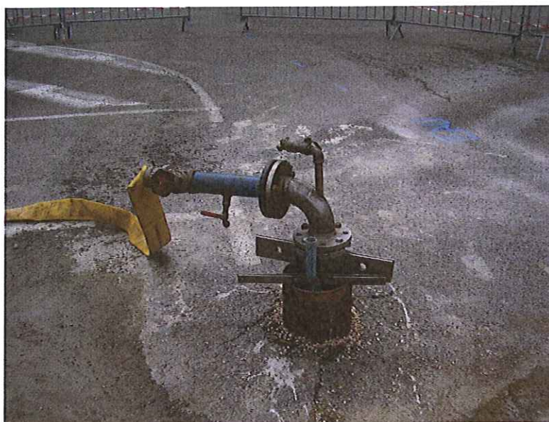
Rejet dans le nouveau forage – Test d’absorption
