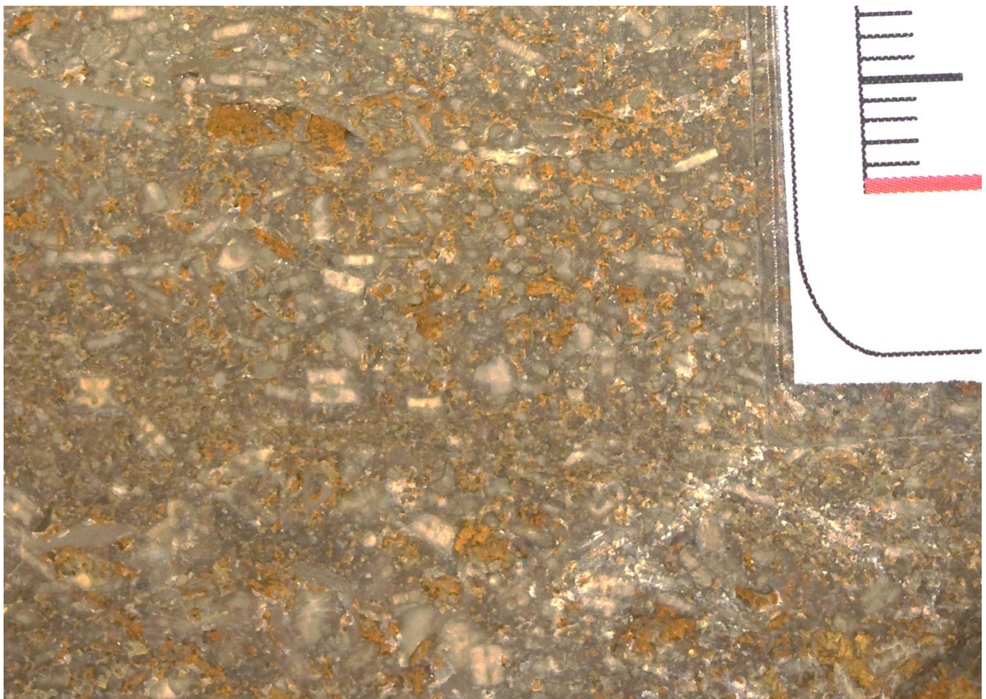
Figure 4 Faciès de l'unité 4 (Calcaire à entroques dans son faciès typique). La plus petite unité de l'échelle est le millimètre.
