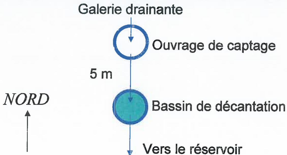
Figure 2 Commune de Vier-Bordes (Hautes-Pyrénées) Source de Passaloup Schéma des installations de captage
