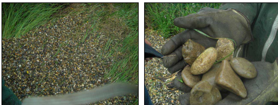
Figure 11 : Matériaux extraits par air-lift
