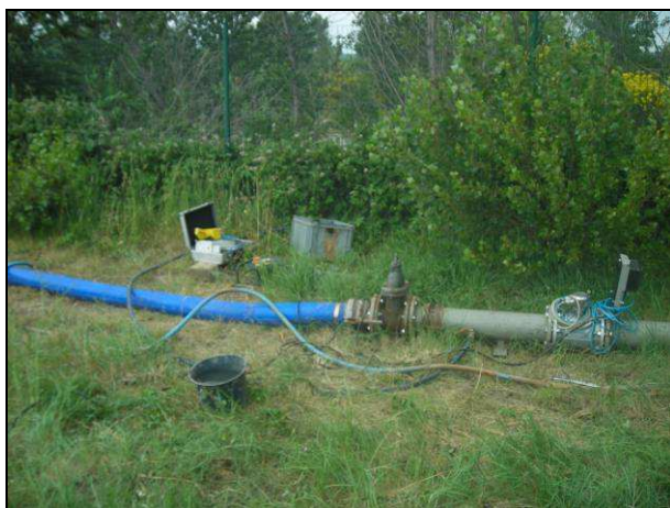
Figure 50 : Installation hydraulique de surface (colonne de refoulement, débitmètre, rejet dans l'Aigues)
