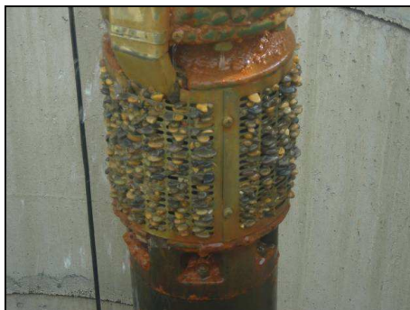
Figure 9 : Crépine de la pompe criblée de graviers
