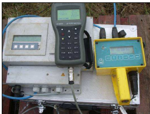
Figure 52 : Turbidimètre, sonde multi paramètres, centrale d'acquisition
