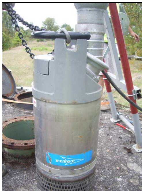
Figure 48 : Pompe d'essai FLYGT 2670 MT
