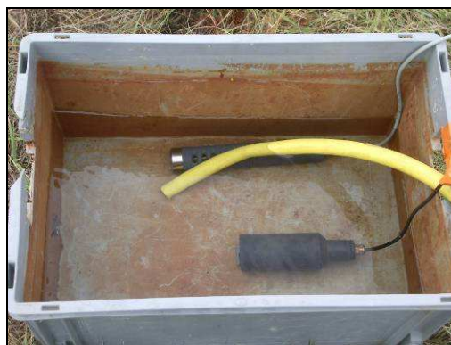
Figure 52 : Turbidimètre, sonde multi paramètres, centrale d'acquisition
