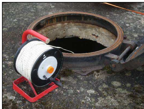
Figure 51 : Sonde piézométrique lumineuse
