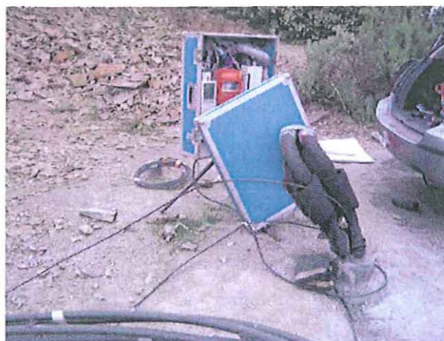
Figure 6. Raccordement et isolation soignée des tubes de la SGV au Mini-module de chauffage.
