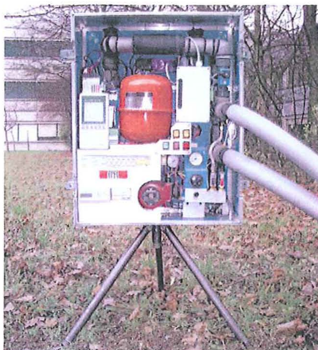
Figure 4. Vue du module de chauffage de l'EPFL, utilisé pour le test de réponse.
