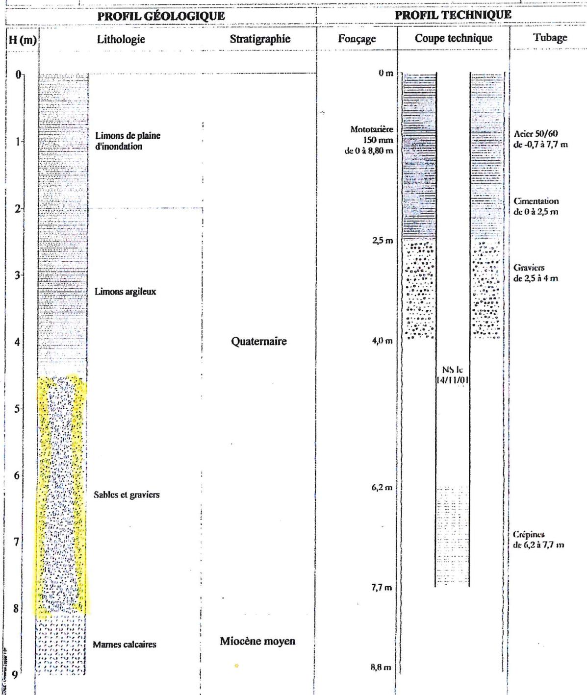
Piezomètre mis en place après passage à la mototarière en diamètre 150 mm.
