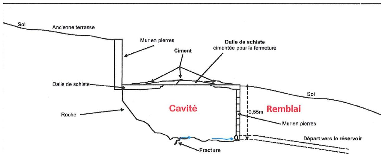
**Fig. 6 – Plan et coupe schématiques du captage**
