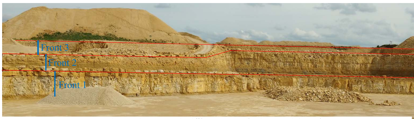
Figure 4 : Photographie montrant les différents niveaux d'exploitations de la carrière.
