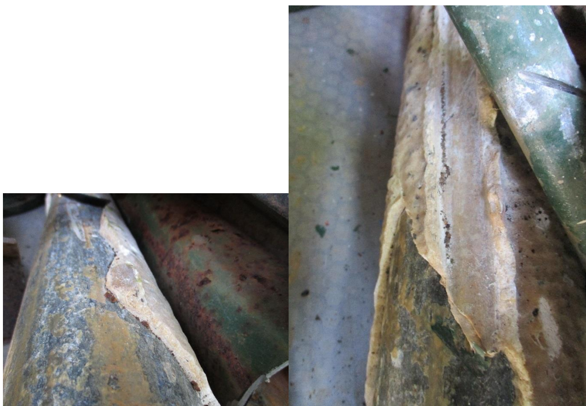
Figure 3 : Colonnes d'exhaure avec forte concrétion carbonatée
