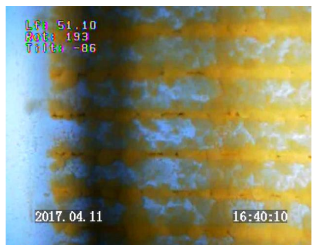
Prof 51.70 m : crépines colmatées par des floccs ferro-bactériens globuleux / côté plus dégradé du tube crépiné
