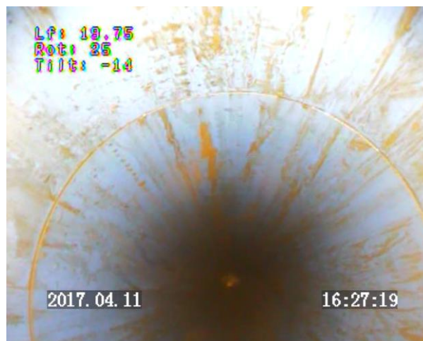
Prof 19.75m : raccord vissé entre deux tubes PVC pleins avec des traces d'hydroxydes de fer
