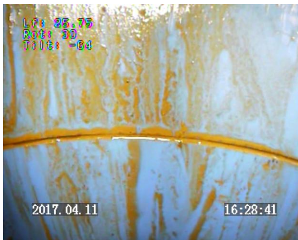
Prof 25.75 m : raccord vissé entre deux tubes PVC pleins avec des traces d'hydroxydes de fer
