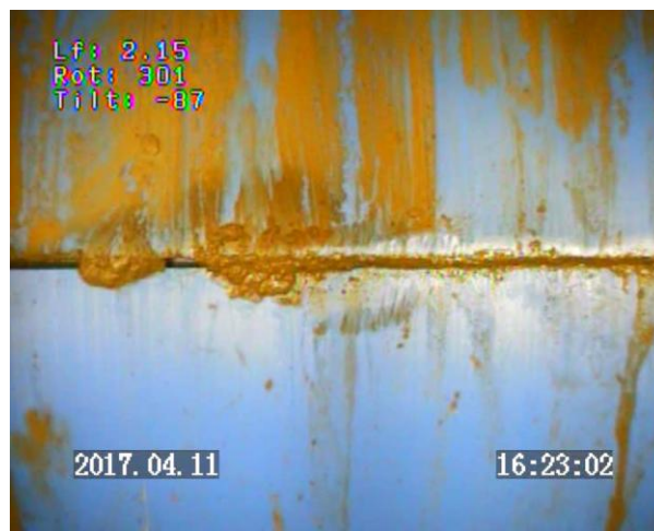
Prof 2.15 m : raccord vissé entre deux tubes PVC pleins partiellement recouvert d'hydroxydes de fer
