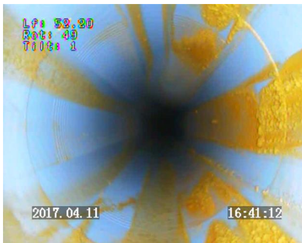
Prof 52.20 m : vue axiale sur le tube crépiné / colmatage hétérogène des crépines
