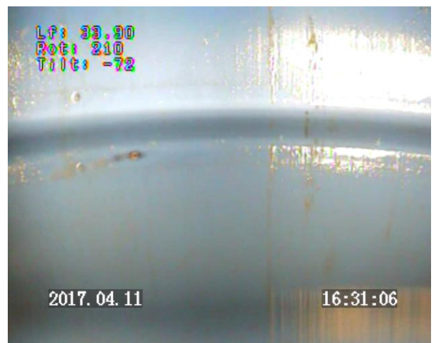
Prof 33.90 m : vue sur la surface piézométrique / eau très peu turbide
