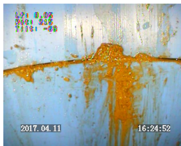
Prof 8.05 m : raccord vissé entre deux tubes PVC pleins partiellement recouvert d'hydroxydes de fer
