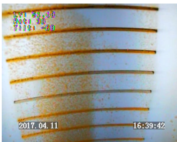
Prof 51.10 m : crépines bien ouvertes / côté propre du tube crépiné
