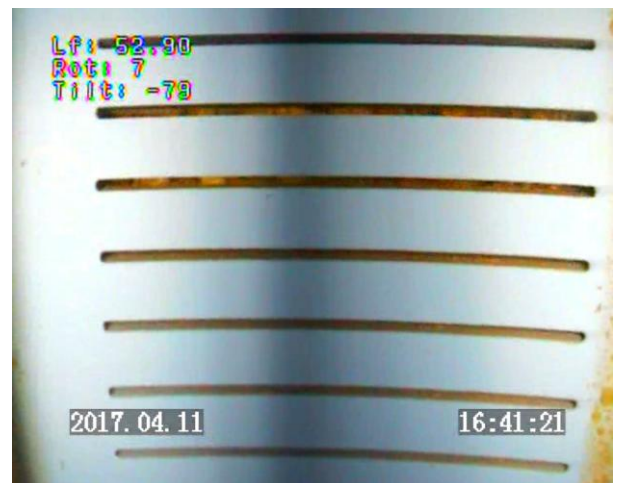
Prof 52.90 m : crépines bien ouvertes / massif gravillonnaire observable au travers des fentes
