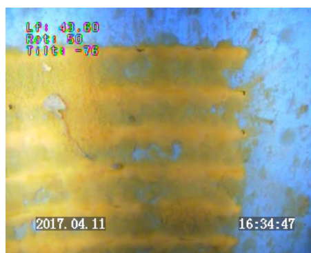
Prof 43,60 m : premières crépines / fentes colmatées par des floccs ferro-bactériens / voile bactérien
