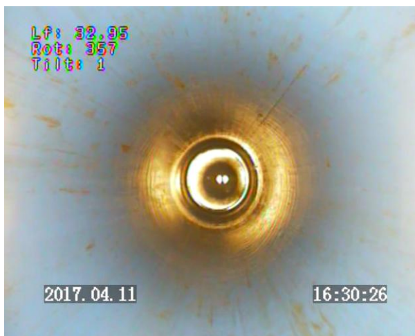
Prof 32.95 m : vue axiale du tube plein PVC Ø 163-180 mm / tube propre
