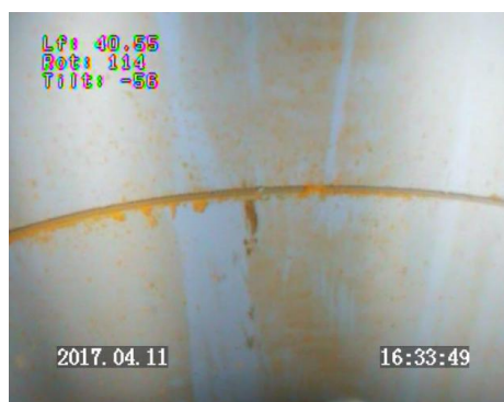
Prof 40,55 m : raccord vissé entre deux tubes PVC pleins / parois avec des traces d'hydroxydes de fer
