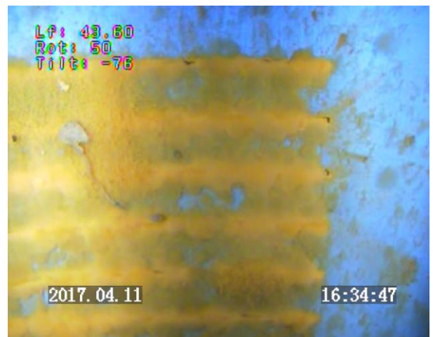
Prof 43.60 : premières crépines / fentes colmatées par des floccs ferro-bactériens / voile bactérien
