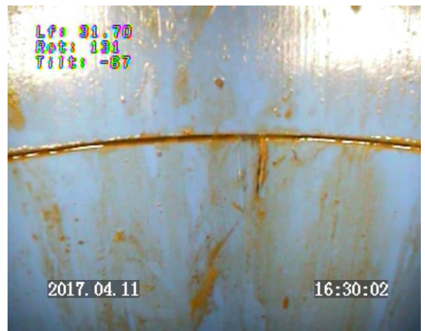
Prof 31.70 m : raccord vissé entre deux tubes PVC pleins avec des traces d'hydroxydes de fer
