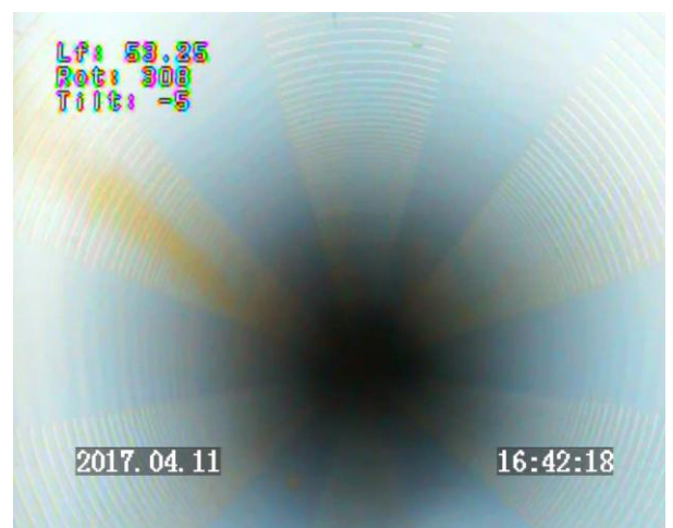
Prof 53.25 m : vue axiale sur les crépines / tube très propre
