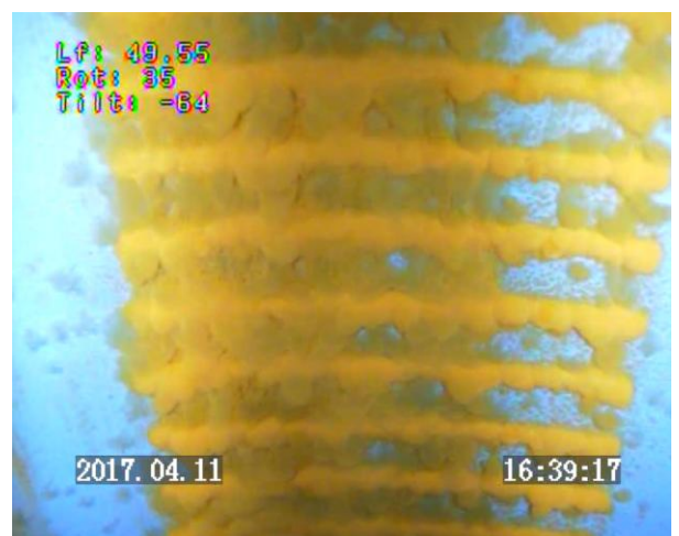
Prof 49.55 m : crépines colmatées par des floccs ferro-bactériens globuleux
