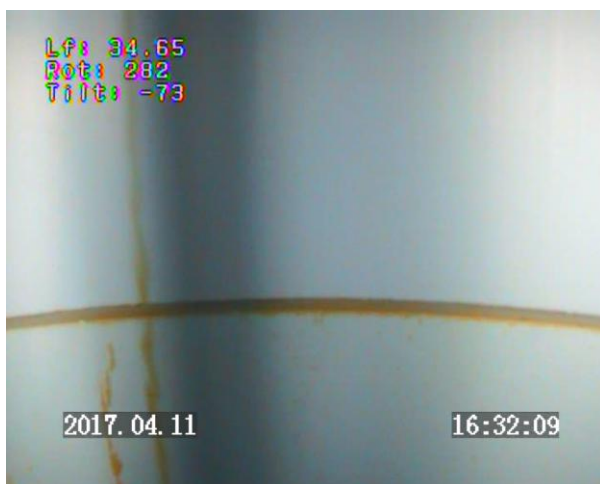
Prof 34.65 m : raccord vissé entre deux tubes PVC pleins / parois propres
