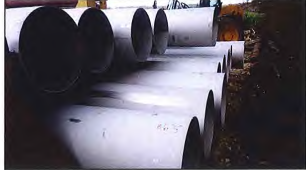
Photo 2 : Tube inox Ø 558 mm
