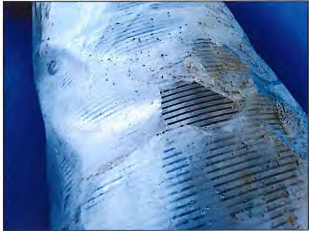
Photo 8 : Crépines de slot 1,5 mm
