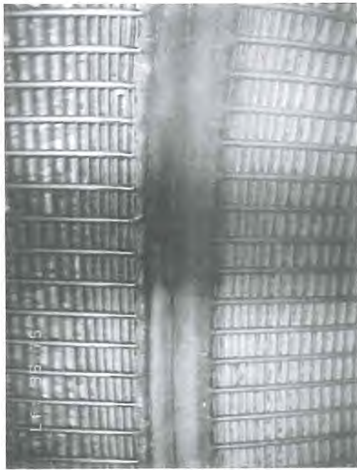
9- Tubage inox crépiné (-35.75 m) – soudure inter-tubages en bon état
