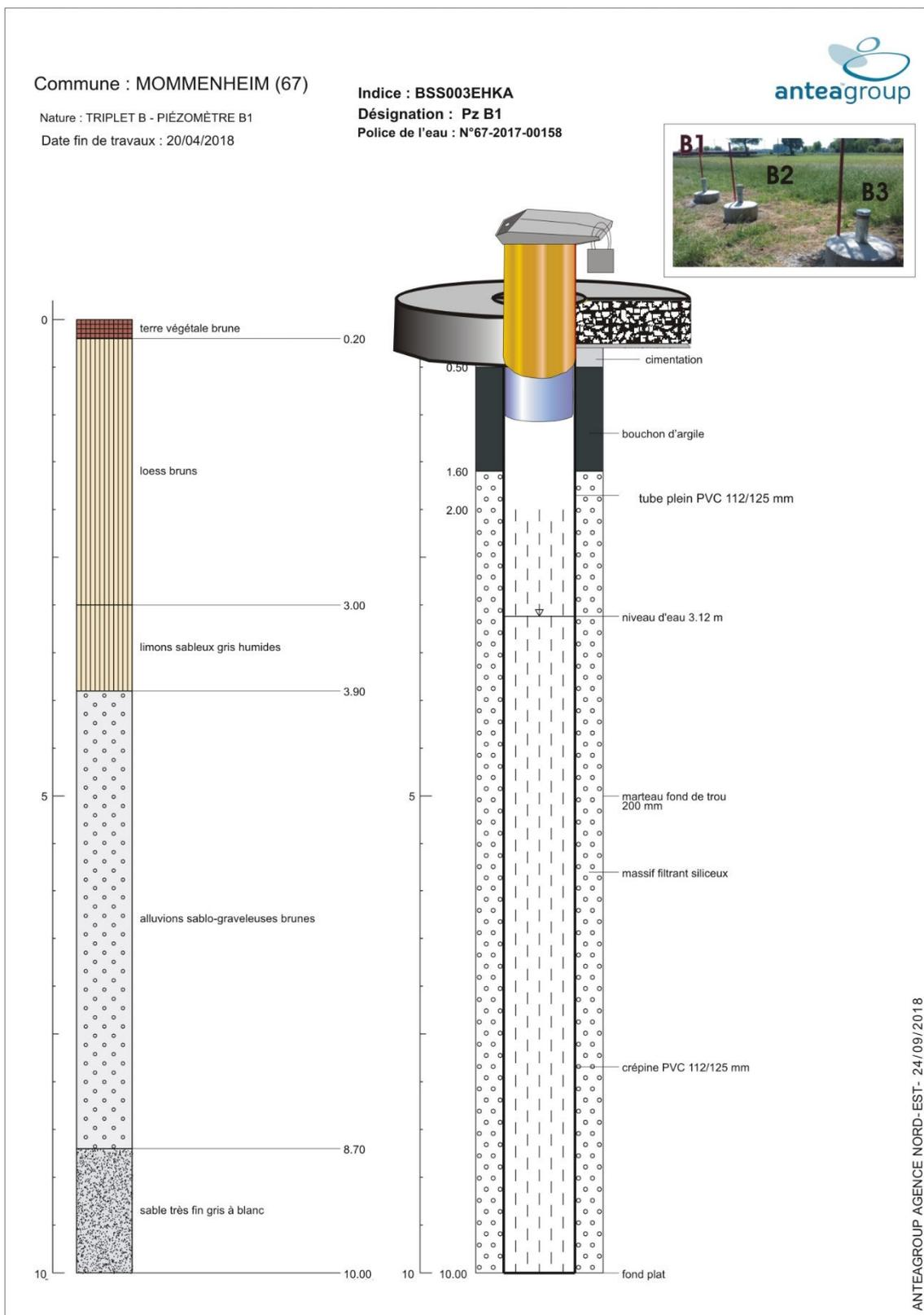
Figure 6 : Coupe géologique et technique du piézomètre BSS003EHKA (Pz B1)
