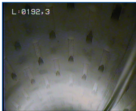
Crépine partiellement colmatée
