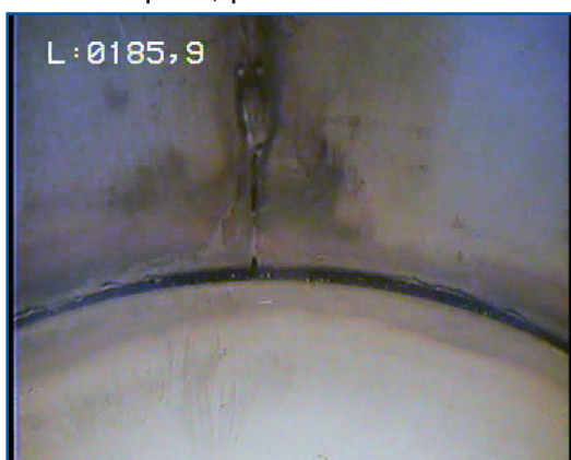
Vue sur un joint et auréole de soudure
