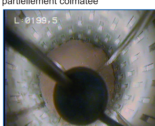
199.9m : fond avec dépôts fins
