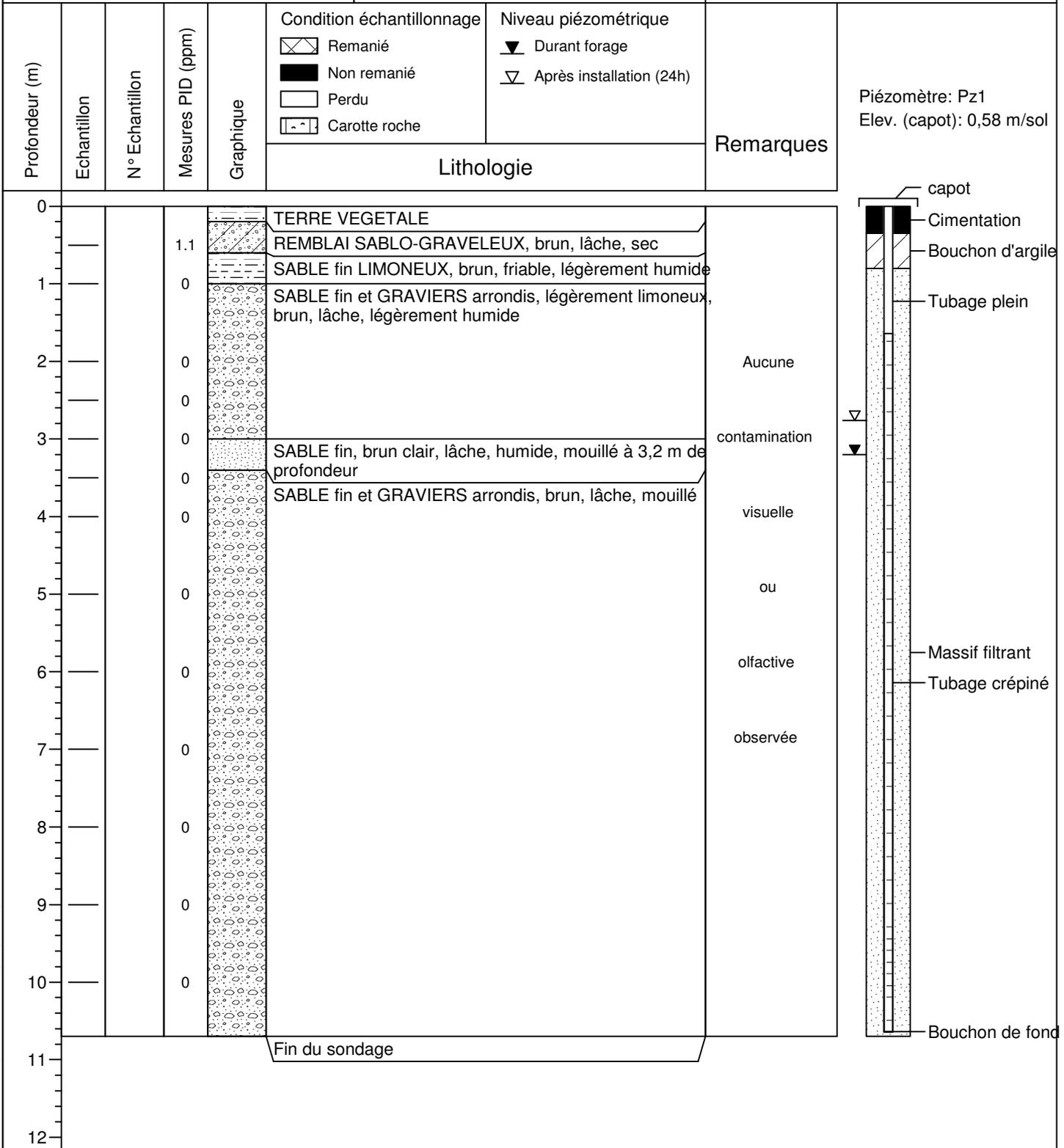
Type tube puits (PVC, PEHD, acier, inox) : PEHD
