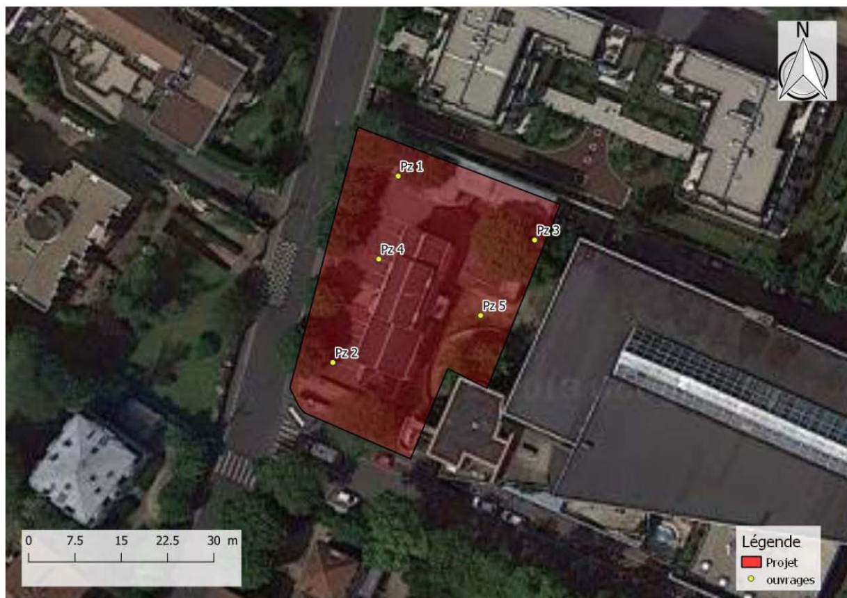
Implantation des piézomètres
