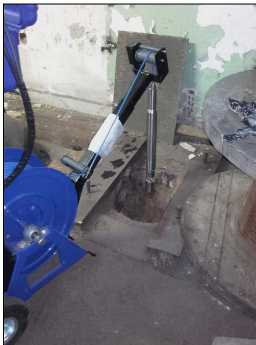
Mise en place de la caméra sur le forage Sud
