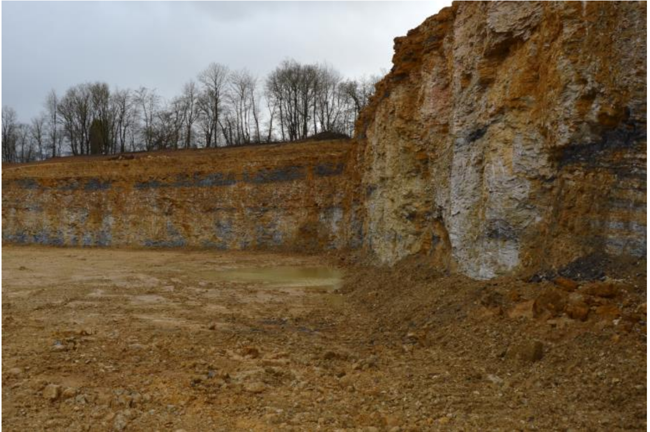
Photo 3 : Vue sur le front de taille supérieur (Calcaire à polypiers, niveau supérieur)
