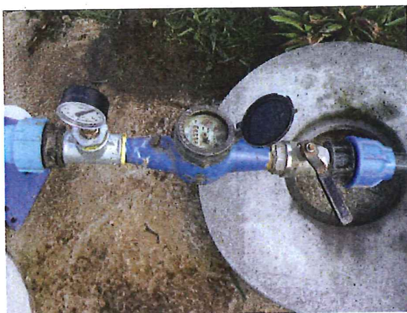
Dispositif de vanne, compteur volumétrique et manomètre Rejet durant le pompage d'essai
