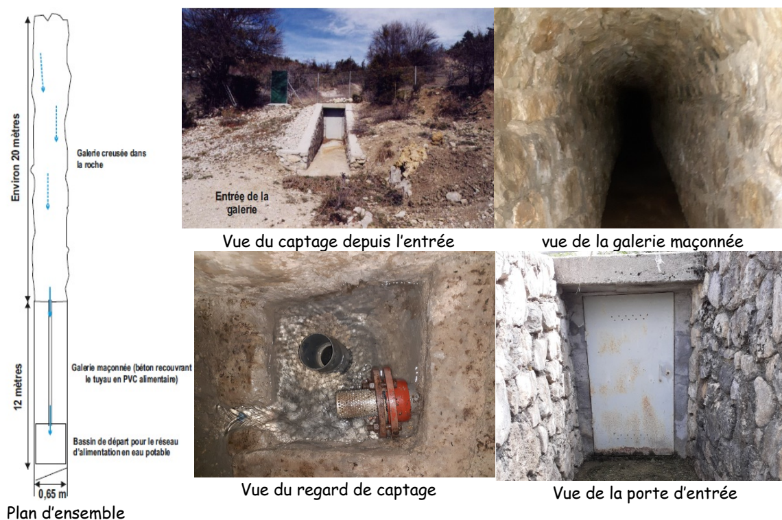
Figure 6 : Caractéristiques techniques du captage de la source de la Sagne (d'après H2EA modifié)
