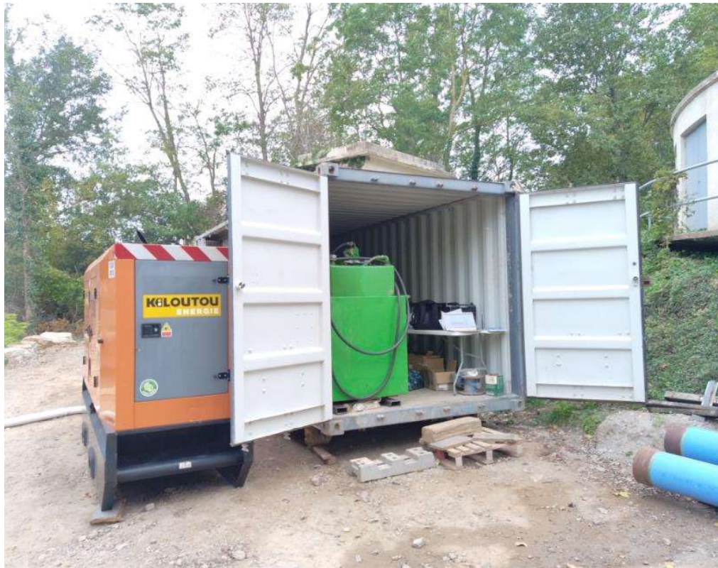
Figure 15 – Photographies du 15 octobre 2020 Groupe électrogène et container mobile de pompage
