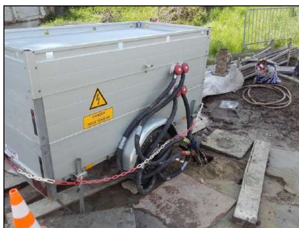
Réalisation du test de réponse thermique (TRT)
