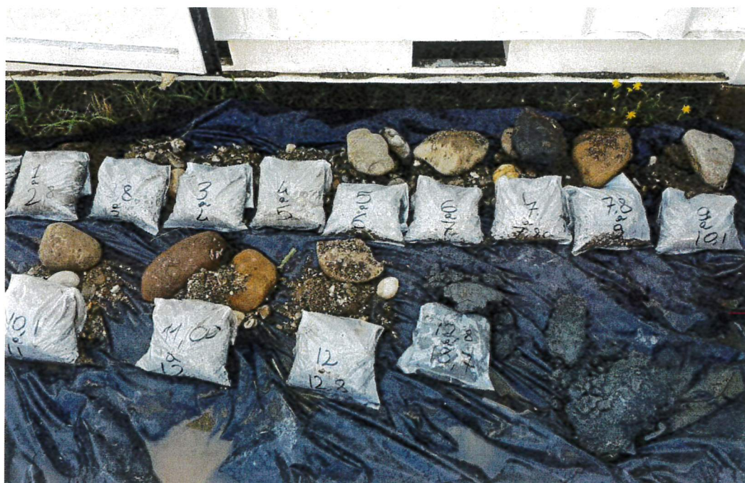
Figure 6 : Déblais du forage
