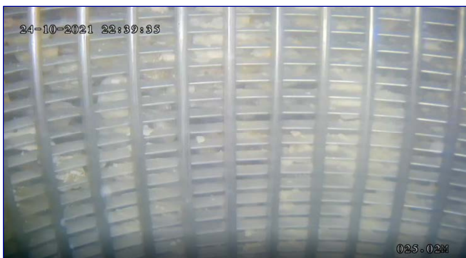
FIGURE 4: SANOFI-COMPIEGNE, OBSERVATION DE L'ETAT DU FORAGE FP1 A -25,02M
