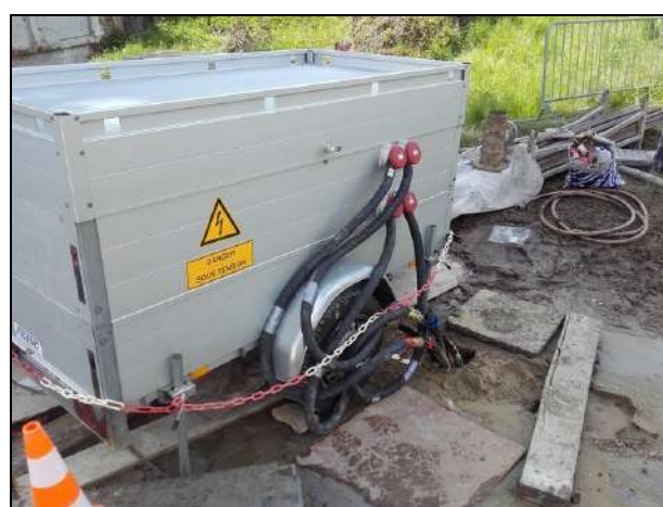
Réalisation du test de réponse thermique (TRT)
