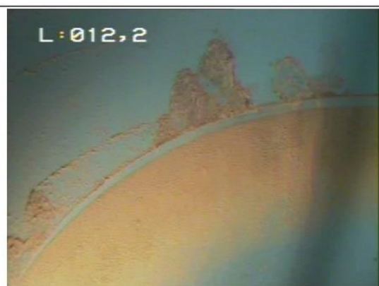
Photo 3 : Quelques légères traces de dépôts sont visibles au niveau du raccord
