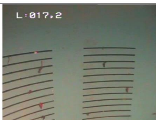
Photo 4 : fentes horizontales avec raccord du tubage crépiné à -17,0 m.
