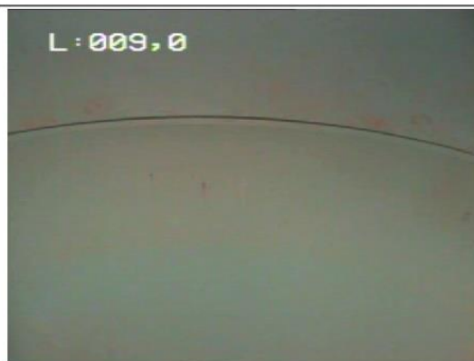
Photo 2 : Idem photo 1. Le niveau d'eau a été rencontré à -7,2 m/repère (Sommet du tubage PVC dans l'avant-puits).
