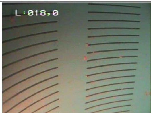
Photo 7 : La paroi du tubage en PVC 411/450 mm est propre.
