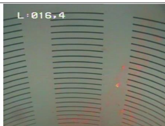
Photo 4 : 1 ères fentes horizontales avec raccord du tubage crépiné à -16,2 m.
