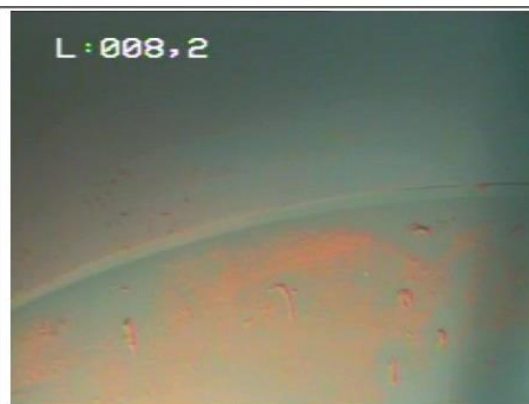
Photo 2 : Idem photo 1. Dans l'eau, la paroi du tubage plein est propre.
