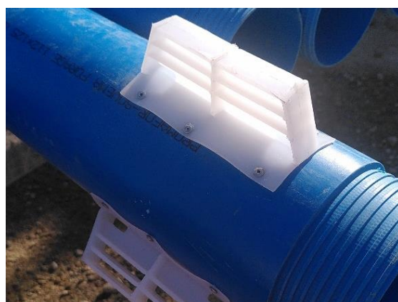
Tube PVC avec centreur riveté
