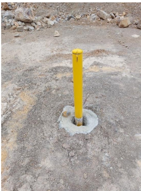
Figure 10 : Piézomètre P5 avant réalisation de la dalle
