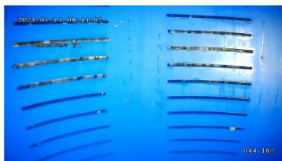
Vue radiale de la crépine PVC Ø 180 x 200mm – 44.16m
