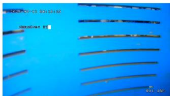
Vue radiale de la crépine PVC Ø 180 x 200mm – 51.16m
