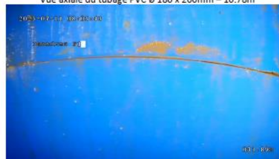
Vue radiale de la jonction tube plein / crépine – 31.89m
