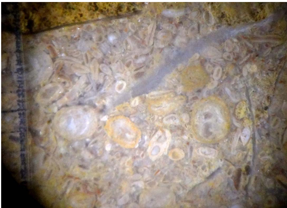
Fig. 11 : Echantillon CHA 6 : Lithofaciès de l'unité 5 de la coupe ouest (Marnes de Longwy). Surface sciée traitée à l'acide chlorhydrique. Echelle millimétrique.
