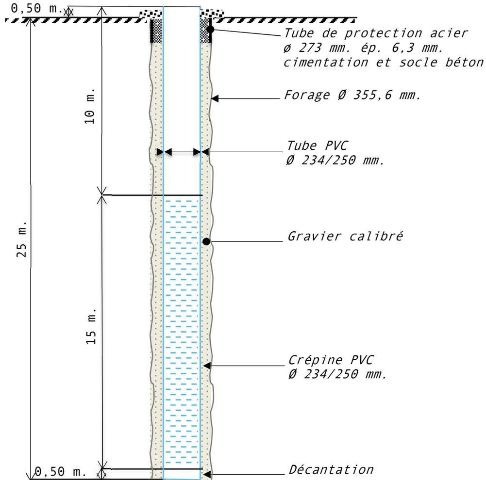
Forage effectué au battage : $\varnothing$  : 355,6 mm.
