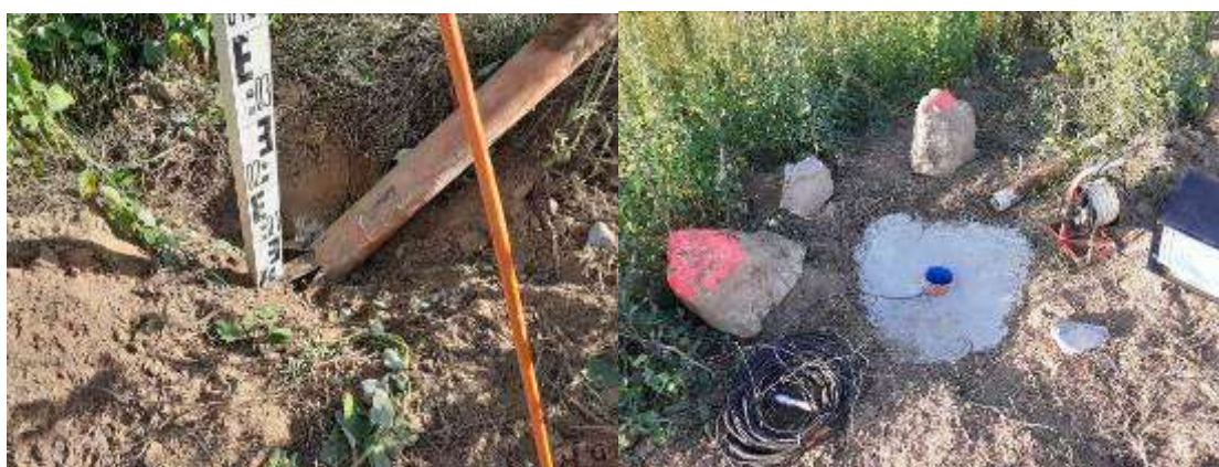
Figure 50 : Piézomètre Pz6 après sa découverte (gauche) / piézomètre Pz6 après une réhabilitation partielle (droite)
