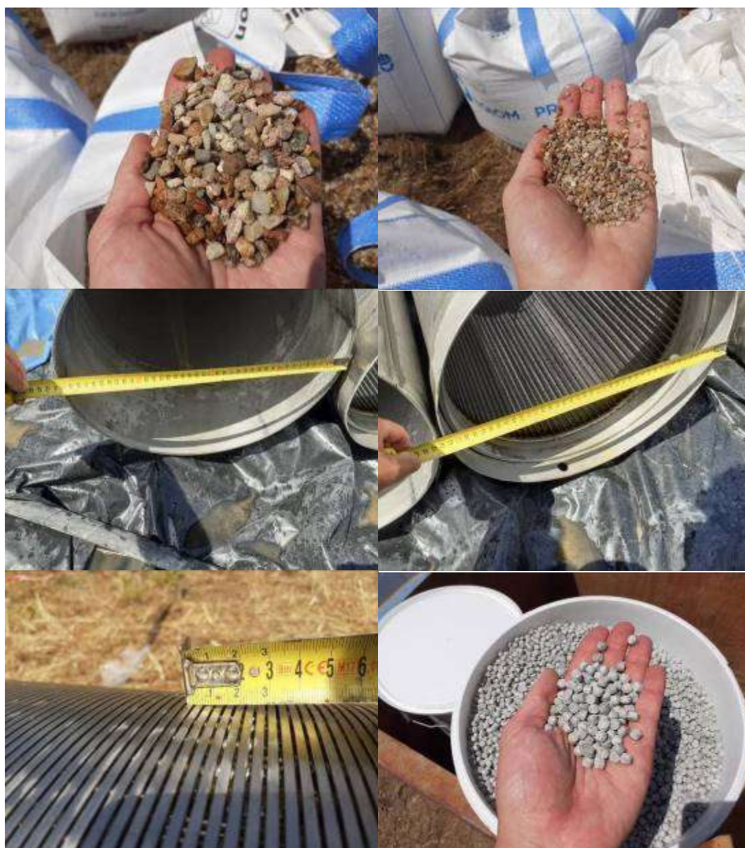
Figure 8 : Contrôle de l'équipement (diamètre d'équipement, slot et calibres de gravier additionnel)
