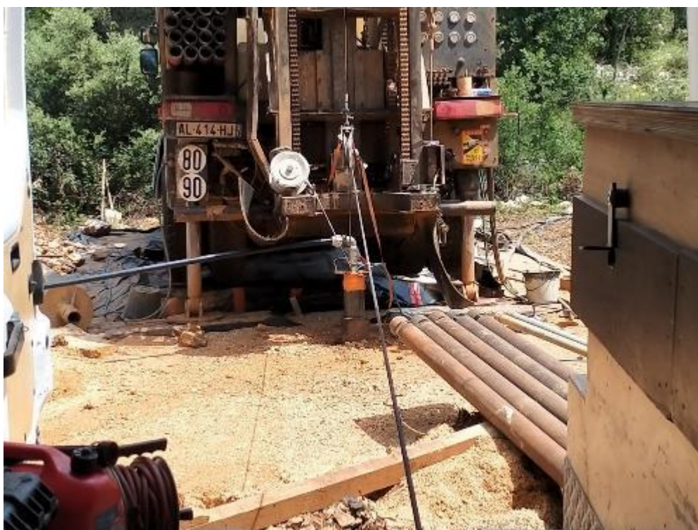
Figure 9 : Diagraphie micro-moulinet
