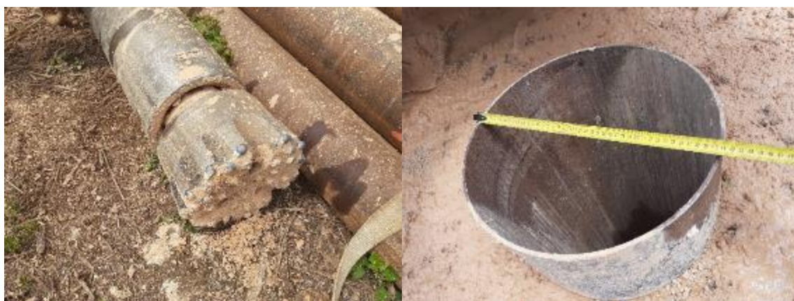
Figure 5 : Taillant ODEX Ø400 mm (gauche) et pré-tubage acier Ø406 mm
