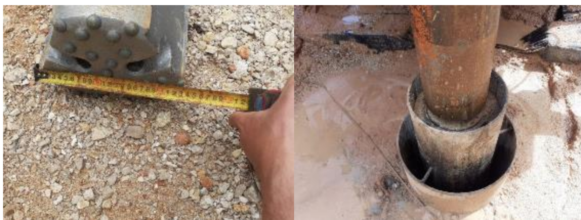
Figure 5 : Taillant ODEX Ø400 mm (gauche) et pré-tubage acier Ø406 mm
