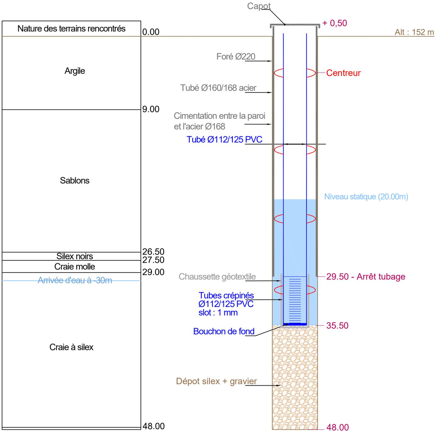
Résultat de pompage : Niveau statique - 20.00m pour 15m³/h, Niveau dynamique - 20.60m (après 3 h)
