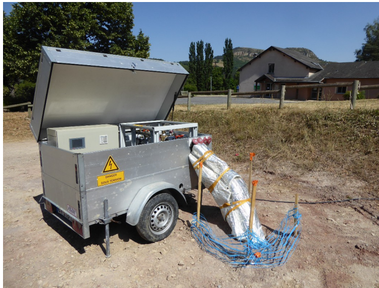
Test de Réponse Thermique réalisé à CHIRAC.
