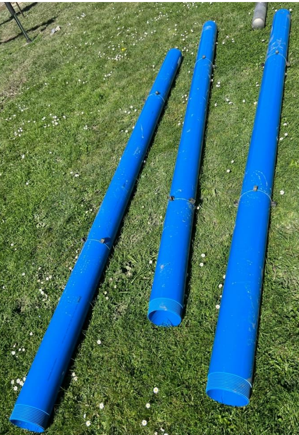
Figure 4 : Tubage PVC et crépine inox
