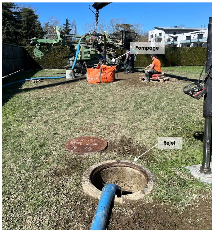
Figure 8 : Dispositif de l'essai de pompage avec rejet dans le réseau d'eaux pluviales
