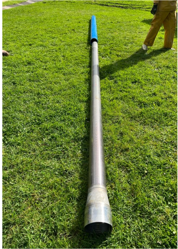
Figure 4 : Tubage PVC et crépine inox
