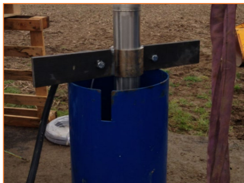
Figure 7 : Collier de serrage permettant le maintien de l'ensemble
